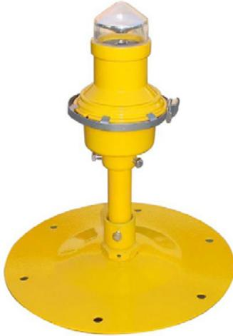
Luminaria de señalización exterior perimetral, montaje de sobreponer. Los componentes son fabricados en fundición de aluminio base y poste en acero rolando en frío. Acabado en pintura en polvo poliéster de aplicación electrostática color amarillo y curada al horno. Equipada con módulo de LED de 4W, disponible en color blanco, azul, verde, amarillo o rojo. Con opción a luz infrarroja para visión nocturna (NVG's). Driver electrónico integrado 120VCA o 240 VCA.
