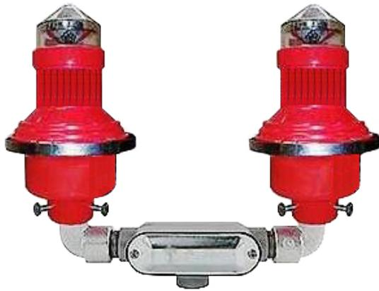
Luminaria de luz de obstrucción sencilla o doble para condiciones normales o extremas (Áreas Clasificadas Clase I, Div. 2., Gpos. A, B, C, D.) Cuerpo y componetes fabricados en fundición de aluminio. Acabado en pintura en polvo poliéster mediante aplicación electrostática color rojo y curada al horno. Difusor de policarbonato de alta resistencia y termosellado. Equipada con módulo LED de 3.8W con driver electrónico integrado 120 VCA, 240 VCA o 277 VCA.
