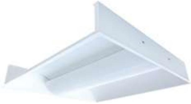
Luminaria ligera para empotrar. Es fabricada con lámina de acero rolado en frío 1010, acabado en pintura en polvo poliéster mediante aplicación electrostática color blanco y curada al horno. Este modelo cuenta con una pantalla fabricada en lámina de acero, la cual es microperforada y recubierta con una película de policarbonato C-9. Equipada con tabletas LED 11W, 16W o 24W, con driver electrónico multivoltaje 120-277 VCA atenuable 0-10 volts con opción a batería de emergencia.
