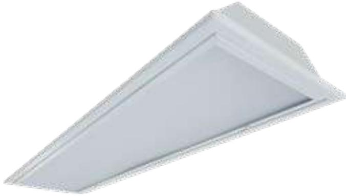
Luminaria para empotrar en plafón de tablaroca. Fabricada en lámina de acero rolada en frío 1010, acabado en pintura en polvo poliéster mediante aplicación electrostática color blanco y curada al horno. Con difusor de acrílico prismático transparente tipo N-12, N-19, N-23 o acrílico opalino
