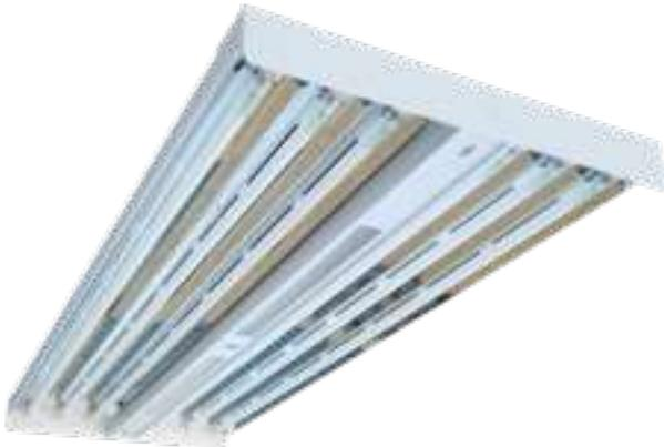
Luminaria de sobreponer o colgar ideal para grandes alturas. Fabricada con lámina de acero rolado en frío 1010, acabado en pintura en polvo poliéster de aplicación electrostática color blanco y curada al horno, con 93.0% de reflectancia. Cuenta con reflector de aluminio especular. Equipada con tableta(s) LED de 16W, 24W, 28W o con driver electrónico multivoltaje de 120-277 VCA atenuable 0-10 Volts, con opción a batería de emergencia.
