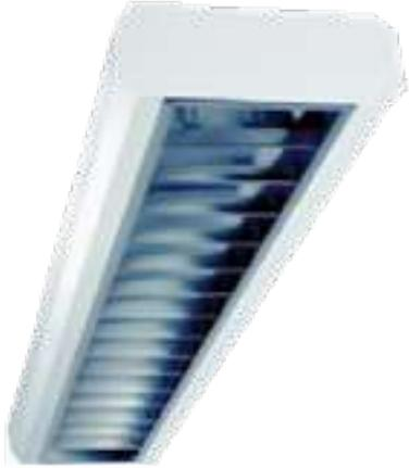
Luminaria de interiores moderna de sobreponer o suspender. Fabricada con lámina de acero rolado en frío 1010, acabado en pintura en polvo poliéster mediante aplicación electrostática color blanco y curada al horno. Incluye louver parabólico hecho de aluminio con diseño escalonado con 10 o 20 celdas en acabado espejular o semiespejular. Equipada con tabletas LED 11W, 16W o 24W, con driver electrónico multivoltaje 120-277 VCA atenuable 0-10 volts con opción a batería de emergencia.
