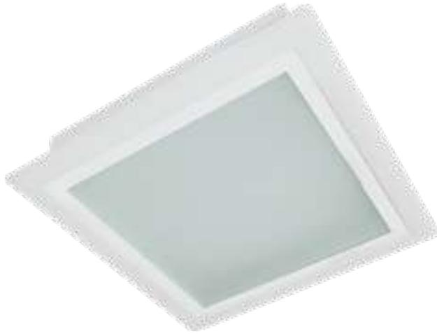
Luminaria compacta de interiores para empotrar en plafón. Fabricada en lámina de acero rolada en frío 1010. Con la opción a marco abatible o fijo, cuenta con acabado en pintura en polvo poliéster de aplicación electrostática, disponible en color blanco y curada al horno.
