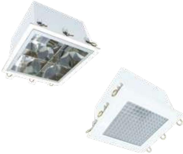
Luminaria de interiores cuadrada para empotrar en plafón. Ésta es fabricada con lámina de acero rolando en frío 1010, acabado en pintura en polvo poliéster mediante aplicación electrostática color blanco y curada al horno. Louver parabólico hecho de aluminio con celdas de acabado especular, semiespecular, blanco o louver reticular cuadrado tipo thin cell de aluminio en color blanco. Fijación por medio de clip con resortes.
