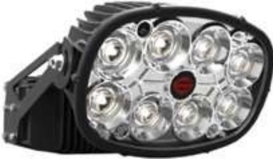
Luminaria tipo reflector de alta potencia LED, modelo Halcón LED. Fabricado en inyección de aluminio con disipador de calor integrado, juntas selladas con grado de protección IP66. Cuenta con opción a distintas aperturas de haz de luz. Opera módulos de LED de alta eficiencia de 320W y 640W. Equipada con Drive multivoltaje 120-277VCA, 347-480VCA. Opción atenuable 0-10V. Supresor de picos de 10kV.
