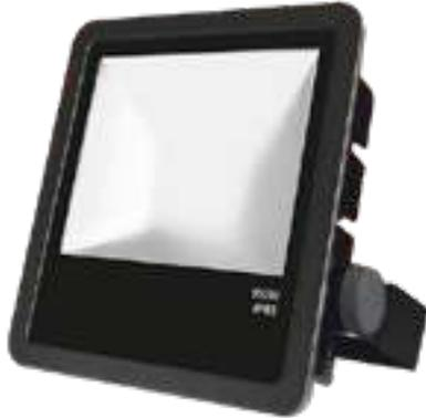
Luminaria tipo reflector. Fabricada en inyección de aluminio, acabado en pintura poliéster de aplicación electrostática color negro. Reflector de aluminio y difusor de cristal termotemplado. Equipada con módulo LED de 80W, 125W o 165W con driver electrónico multivoltaje 100-240 VCA.
