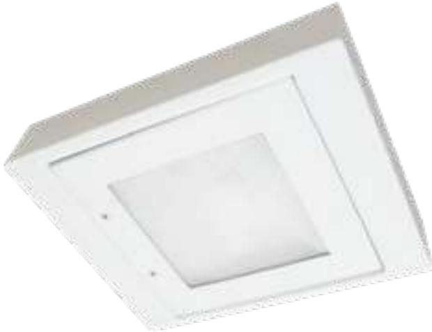
Luminaria de seguridad anti vandálica para sobreponer. Fabricada en lámina de acero rolada en frío 1010 calibre 14, junta sellada con hule neopreno de alta densidad sin bisagras, con 2 tornillos de seguridad tipo TORX, acabado en pintura polvo poliéster de aplicación electrostática en color blanco y curada en horno, con 93.0% de reflectancia.
