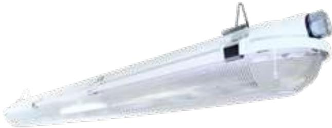
Luminaria hermética para sobreponer o colgar. Fabricada en resina poliéster, fibra de vidrio inyectado de una sola pieza con gel-coat de color blanco o gris, reflector de lámina de acero acabado en pintura en polvo color blanco o bien de aluminio especular, broches de seguridad en plástico ABS. Difusor acrílico opalino, texturizado o de bajo peralte de alto impacto termoformado, sellado con poliuretano expandido.
