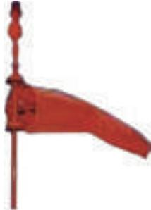
Indicador visual de dirección y velocidad del viento, con acoplamiento de ruptura en su base (cople frágil). Rodamientos de aluminio presolados a los ensambles y protector de cojinetes para la intemperie. Colector (manga) de nylon tratado para evitar la putrefacción, moho y humedad.
