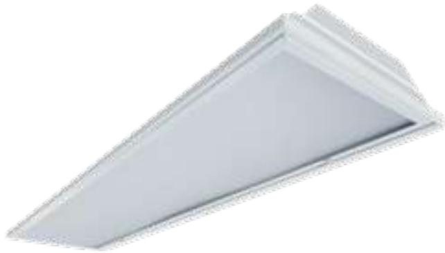
Luminaria de interiores para empotrar en plafón reticular modelo Modular. Esta es fabricada con lámina de acero rolado en frío 1010, acabado en pintura en polvo poliéster mediante aplicación electrostática color blanco, curada al horno, opción a marco fijo o abatible.
