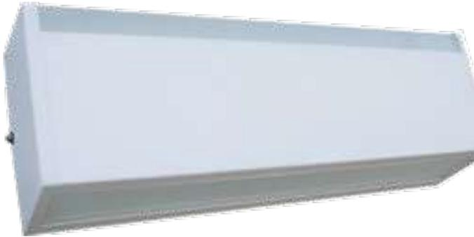
Luminaria especial para sobreponer en muro, para uso en hospitales. Fabricada con base de lámina de acero rolada en frío 1010, acabado en pintura en polvo poliéster mediante aplicación electrostática color blanco y curada al horno. Con doble difusor acrílico prismático transparente termoformado para iluminación directa e indirecta.
