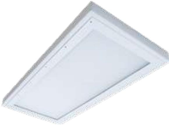
Luminaria de seguridad anti vandálica para sobreponer. Fabricada en lámina de acero rolada en frío 1010 C-14 o C-16, junta sellada con hule neopreno de alta densidad, armado con tornillos de seguridad tipo TORX, acabado en pintura polvo poliéster de aplicación electrostática en color blanco y curada en horno, con 93.0% de reflectancia.
