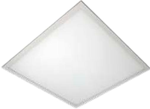
Luminaria tipo Panel LED para montaje empotrado en plafón reticulado. Fabricada en fundición de aluminio, acabado en terminado natural. Opera con módulos de LED 40W o 50W con driver electrónico multivoltaje 120-277 VCA, opción atenuable 0-10V. Disponible en 3500°K, 4000°K y 5000°K.
