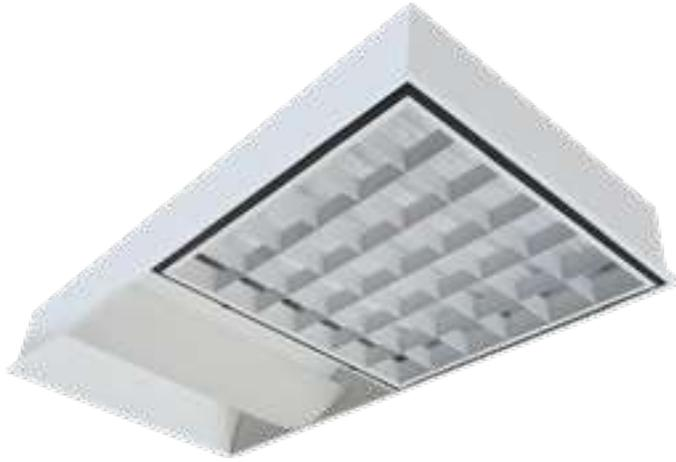
Luminaria de interiores para empotrar o sobreponer diseñada para revisión y auscultación médica en hospitales. Fabricada con lámina de acero rolado en frío 1010, acabado en pintura en polvo poliéster mediante aplicación electrostática color blanco curada al horno.
