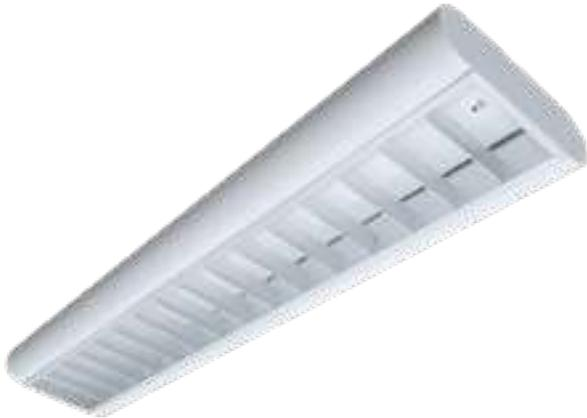
Luminaria de interior moderna. Fabricada con lámina de acero de rolado en frío 1010, disponible con acabado en pintura en polvo poliéster de aplicación electrostática color blanco y curada al horno. Louver parabólico hecho de aluminio con un diseño escalonado con 10 o 20 celdas en acabado especular o semiespecular. Equipada con tabletas LED 11W, 16W o 24W, con driver electrónico multivoltaje 120-277 VCA atenuable 0-10 volts con opción a batería de emergencia.
