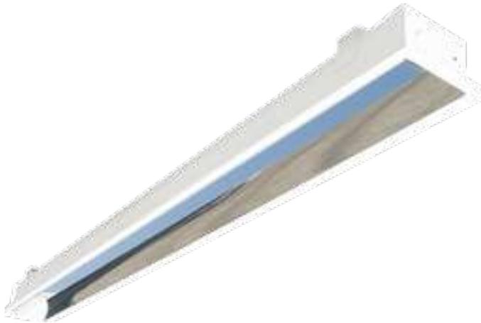
Luminaria de luz asimétrica para acentuación a muros y paredes, diseñada para ser empotrada en plafón. Fabricada a base de lámina de acero rolando en frío 1010. Acabado en pintura en polvo poliéster mediante aplicación electrostática color blanco y curada al horno.
