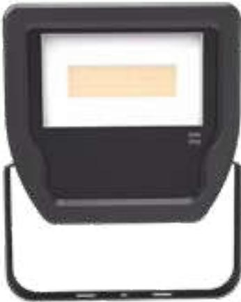
Luminaria tipo reflector. Fabricada en inyección de aluminio, acabado en pintura poliéster de aplicación electrostática color negro. Reflector de aluminio y difusor de cristal termotemplado.
