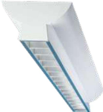
Luminaria lineal de luz directa e indirecta para colgar. Fabricada con lámina de acero rolado en frío 1010, acabado a base de pintura en polvo poliéster mediante aplicación electrostática color blanco y curada al horno.
