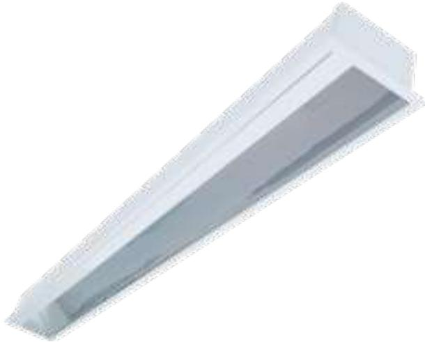
Luminaria con diseño de luz asimétrica para acentuación a muros y paredes, para empotrar en plafón. Fabricada con lámina de acero rolando en frío 1010, acabado en pintura en polvo poliéster de aplicación electrostática color blanco y curada al horno. Reflector de aluminio en acabado especular. Este modelo se equipa con tabletas LED 11W, 16W, 24W o 28W, con driver electrónico multivoltaje 120-277 VCA atenuable 0-10 volts con opción a batería de emergencia.
