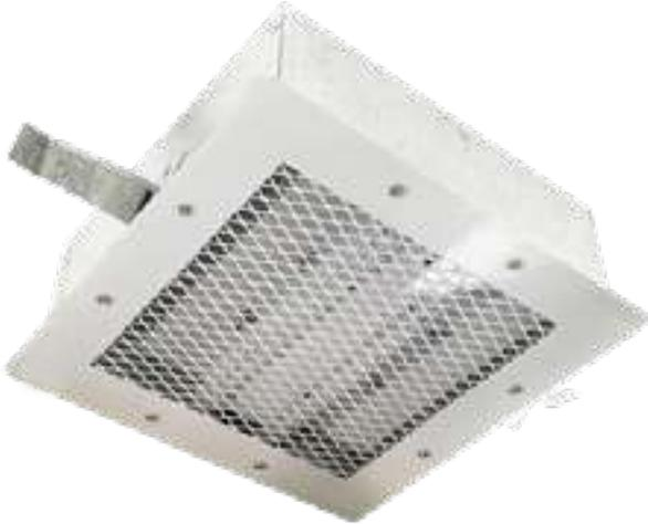
Luminaria de seguridad anti vandálica compacta, sencilla para empotrar en losa (con anclas integradas). Fabricada en lámina de acero galvanizada rollada en frío 1010, bisel con rejilla de metal desplegado, armado con tornillos de seguridad tipo TORX, acabado en pintura polvo poliéster de aplicación electrostática en color blanco y curada en horno, con 93.0% de reflectancia.
