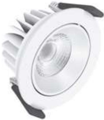
Luminaria para empotrar. Fabricada en inyección de aluminio, acabado en pintura en polvo poliéster color blanco, curada al horno. Aro con sistema escualizable.
