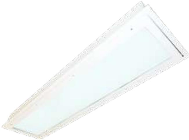
Luminaria de alta seguridad anti vandálica para empotrar en losa. Fabricada en lámina de acero rollada en frío 1010 C-14 o C-16, junta sellada con hule neopreno, armado con 6 u 8 tornillos de seguridad tipo TORX, acabado en pintura polvo poliéster de aplicación electrostática en color blanco y curada en horno, con 93.0% de reflectancia.
