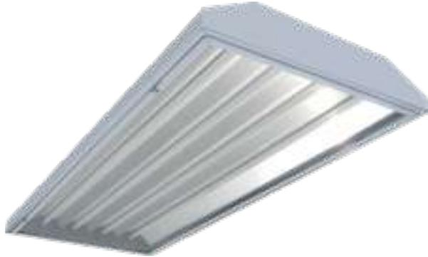
Luminaria de sobreponer o colgar para grandes alturas. Fabricada con lámina de acero rolado en frío 1010, marco abatible, acabado en pintura en polvo poliéster de aplicación electrostática color blanco y curada al horno, con 93.0% de reflectancia. Cuenta con reflector de aluminio especular o en color blanco, difusor acrílico transparente. Equipada con tableta(s) LED de 16W, 24W o 28W, con driver electrónico multivoltaje de 120-277 VCA atenuable 0-10 Volts, con opción a batería de emergencia.
