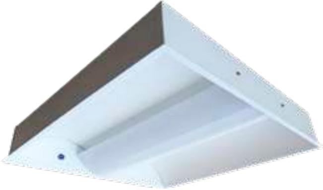
Luminaria de interiores para empotrar. Fabricada con lámina de acero rolado en frío 1010, acabado en pintura en polvo poliéster de aplicación electrostática color blanco y curada al horno. Pantalla fabricada en lámina de acero microperforada y recubierta con una película de policarbonato C-9. Equipada con tabletas LED 11W, 16W o 24W, con driver electrónico multivoltaje 120-277 VCA atenuable 0-10 volts con opción a batería de emergencia.
