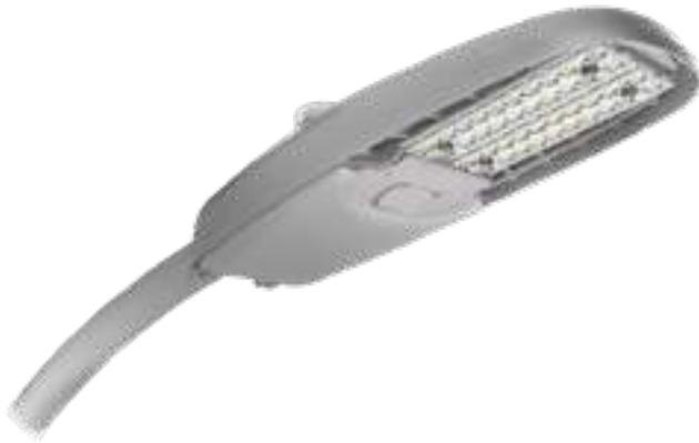
Luminaria para alumbrado público montaje en brazo sobre punta de poste. Fabricada en fundición de aleación de cobre y aluminio. Receptáculo para fotocelda y difusor de calor integrado al cuerpo de la luminaria, acabado en pintura poliéster de aplicación electrostática curada en horno color gris.
