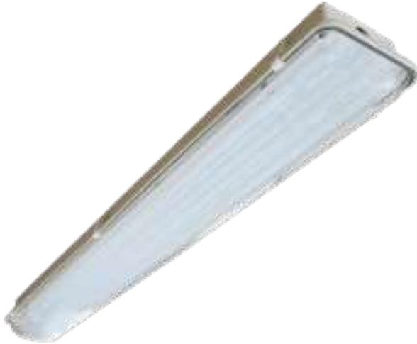
Luminaria hermética para sobreponer o colgar. Fabricada en resina poliéster, fibra de vidrio inyectado de una sola pieza con gel-coat de color blanco o gris, reflector de lámina de acero acabado en pintura en polvo color blanco o bien de aluminio especular, broches de seguridad en plástico ABS. Difusor acrílico opalino o transparente de alto impacto termoformado, sellado con poliuretano expandido.
