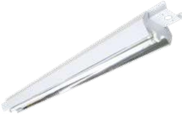
Luminaria ideal para colgar de tira continua. Fabricada con lámina de acero rolando en frío 1010, acabado en pintura en polvo poliéster de aplicación electrostática color blanco y curada al horno, con 93.0% de reflectancia. Reflector en color blanco o aluminio especular de alta reflectancia.
