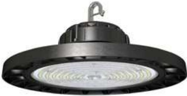
Luminaria profesional para colgar o sobreponer, ideal para grandes alturas. Fabricada en inyección de aluminio terminado en pintura en polvo poliéster de aplicación electrostática color negro mate curada al horno. Difusor policarbonato (110°) transparente resistente al polvo y chorros de agua. Equipado con módulo LED de 120 o 200W. Opera con driver electrónico multivoltaje de 100-277 VCA atenuable 0-10 Volts.
