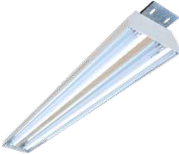
Luminaria ideal para grandes alturas, de sobreponer o colgar en línea continua. Fabricada con lámina de acero rolado en frío 1010, acabado en pintura en polvo poliéster de aplicación electrostática color blanco y curada al horno, con 93.0% de reflectancia.
