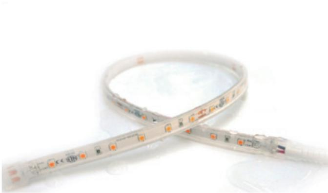
Luminaria tipo tira de LED para sobreponer seccionable cada  $\leq 500$  mm. Fabricada a base de un circuito impreso flexible y encapsulada en una membrana plástica.
